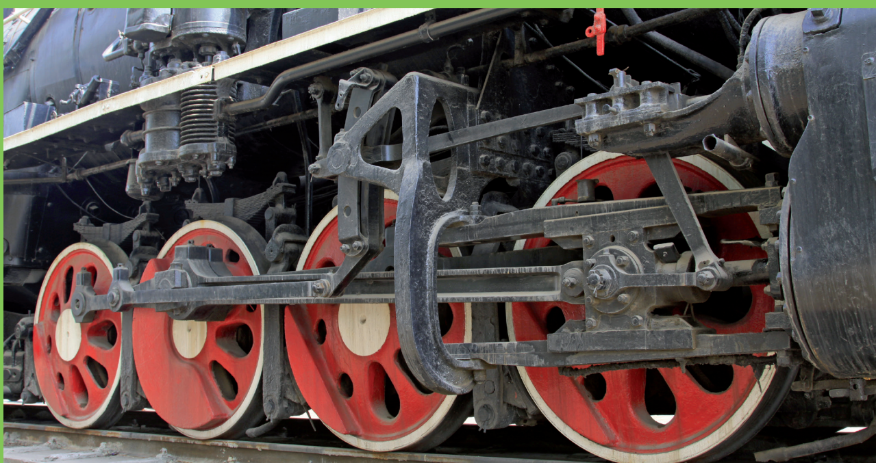
Detail klikového mechanismu s ojnici u historického parního vlaku.
